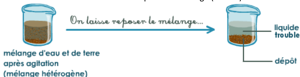
Doc. 1. Principe de la décantation.
